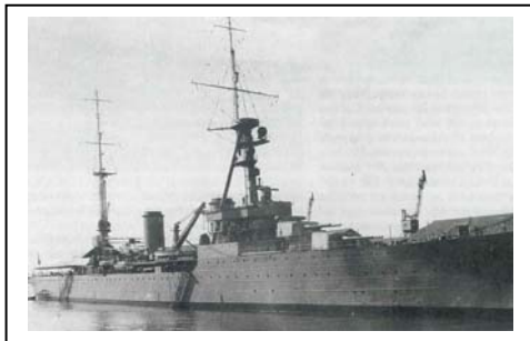
FR Duquesne, Washington krydser, 1928, 10.000 tons, 34 knob, 8 stk. 8 tommers kanoner, 12 torpedoer, næsten ingen panser kun 3½% af det samlede displacement.
