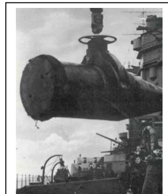
Håndteringen af de 907 kg tunge granater skete med tovværk,
